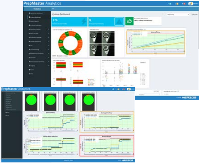
KI-Bilderkennung im Einsatz: Fräsplättchenüberwachung via SmartVision TCM.
